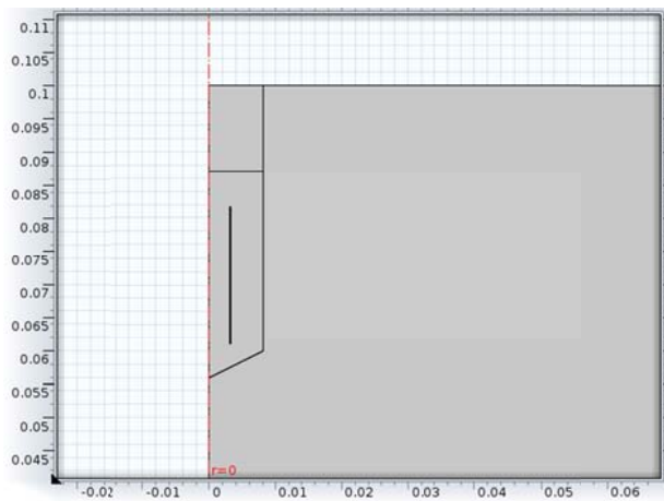
Figur 21. Geometrisk avbildning av borrhålmätning med aktiv del av Vaisala-sensor, betong, rörvägg och innesluten luftvolym.
