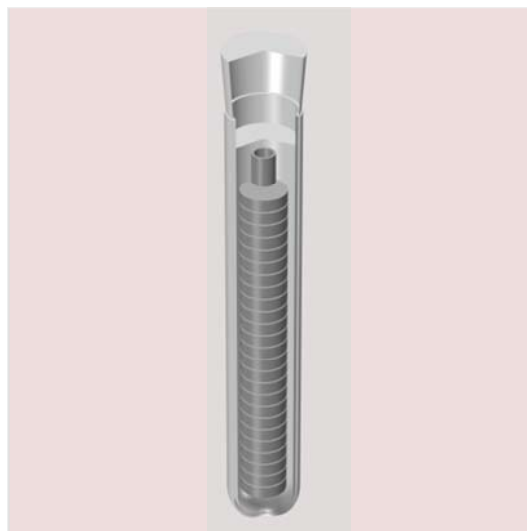
Figur 29. 3D-visualisering av provrör, hel provmängd betong, Testo/Vaisala-sensor och gummiplugg.
